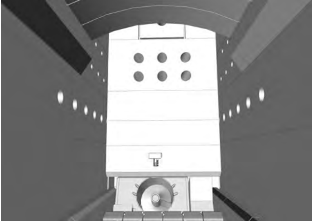
Fig. 2-16: Ouvertures dans le revêtement réfractaire
